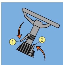
Obr. 4 – Spôsob nastavenia volantu traktora Forterra
