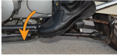
Obr. 3 - Pred zaradením nižšieho prevodového stupňa je dobré pri vypnutej spojke pridať plyn („medzi plyn“), aby sa vyrovnali otáčky motora a prevodovky.
