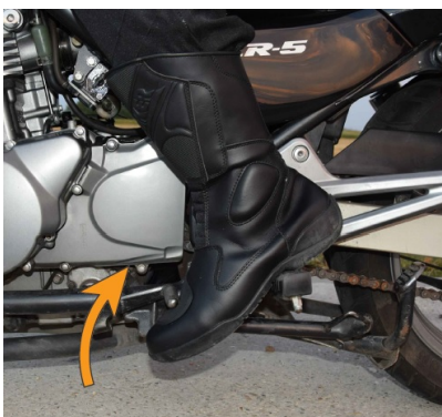
Obr. 2 - Výrazom hore, je všeobecne myslené preraďenie na vyšší prevodový stupeň. Zhodou okolností sa u motocyklov radí vyšší prevodový stupeň skutočne posunutím radiacej páky smerom hore.
