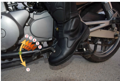
Obr. 1 –Schéma radenia šesťstupňovej prevodovky motocykla
