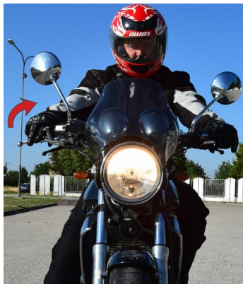
Obr. 3 – Pravou rukou súčasne pridávame plyn a dvoma prstami ťaháme brzdu
